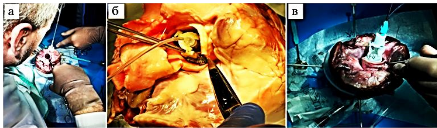
Экспериментальная процедура имплантации разрабатываемого протеза в биопротез «ТиАра» (а, б) и биопротез «ЮниЛайн» (в) для аортальной позиции на модели сердца животного (свиньи).
